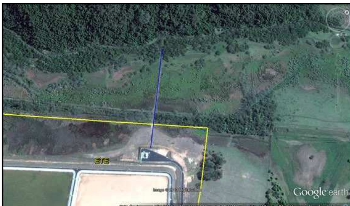
Figura 131 - Disposição final do esgoto tratado.
